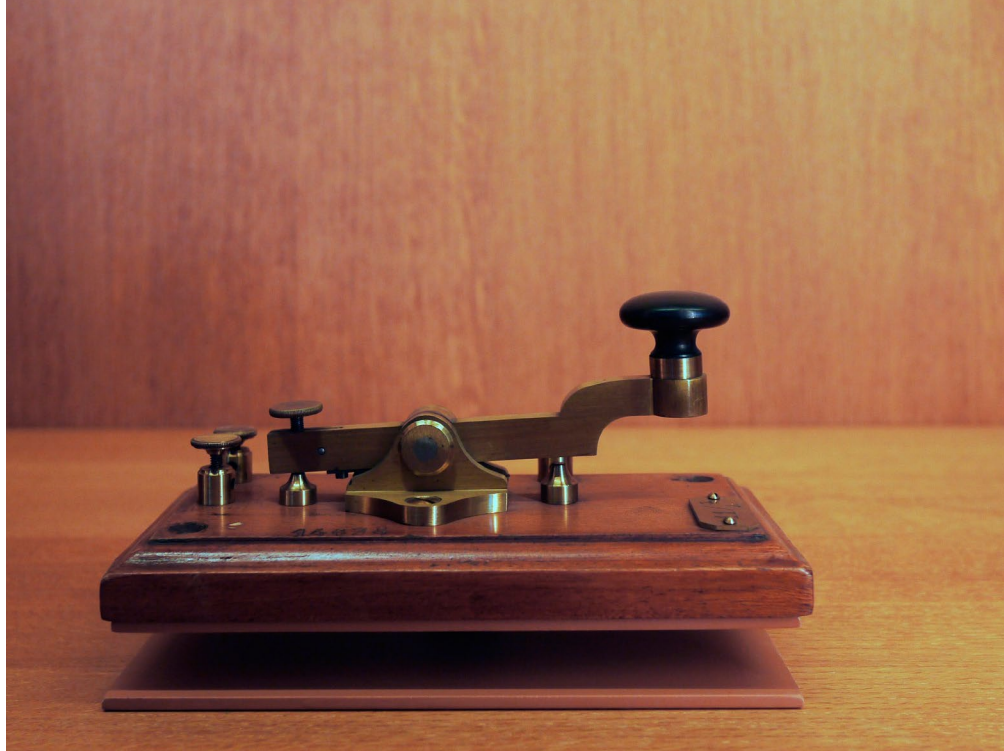
Morsen lyhyisiin ja pitkiin signaaleihin perustuva järjestelmä mullisti sähkötysnopeuden. Yksinkertaisella sähkötysavaimella saattoi taitava sähköttäjä viestiä hyvinkin nopeasti.
